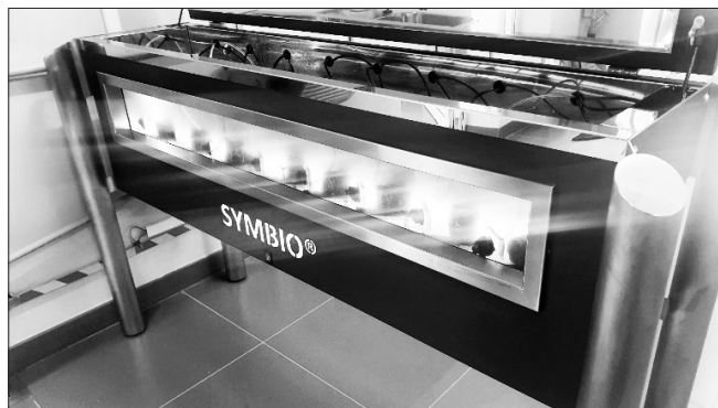
System monitorowania wody wykorzystujący małże słodkowodne Fot. K. Buczkowski
