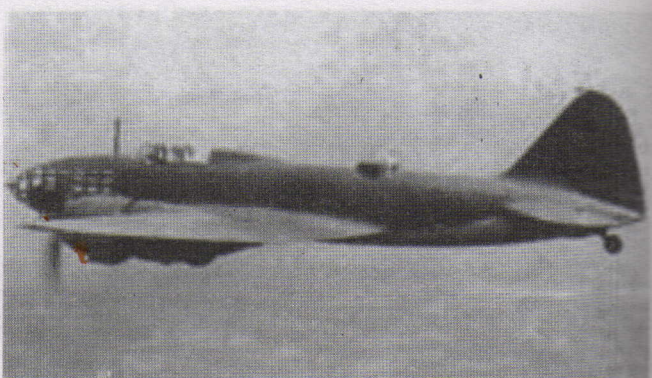
Fot. 10. Iłuszyn Il-4 typ: samolot bombowy • produkcja seryjna: 1940, dane techniczne silnik: 2 x M-88B o mocy 1100 KM każdy • rozp./dł./wys.: 21,44/14,76/4,1 m • masa startowa: 10055 kg • Vmax.: 398 km/h • pułap: 8300 m • zasięg: 4000 km • uzbrojenie: 1 x 12,7 mm, 2 x 7,62 mm, 1000 (2500) kg bomb.
